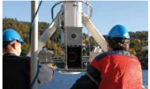
Overvåkning og undersøkelser av testfeltene i Grenlandsfjordene ved hjelp av bl.a. sedimentkjerne, sedimentprofilkamera og grabb. Foto: Marianne Olsen
