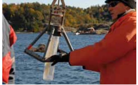
Overvåkning og undersøkelser av testfeltene i Grenlandsfjordene ved hjelp av bl.a. sedimentkjerne, sedimentprofilkamera og grabb. Foto: Marianne Olsen
